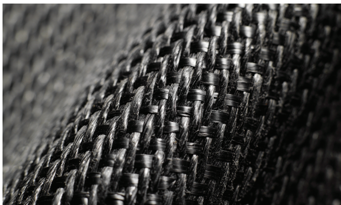
Certifié ASQUAL, TenCate Geolon® PP 60 est un géotextile tissé de bandelettes, constitué de fibres de haut module en polypropylène, qui présente une excellente résistance à l'endommagement lors de l'installation et du compactage de la couche granulaire.
